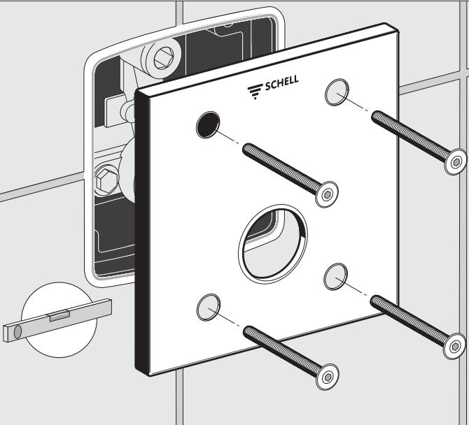
(D) • Frontplatte unter Zuhilfenahme einer Wasseerwaage aufsetzen.
