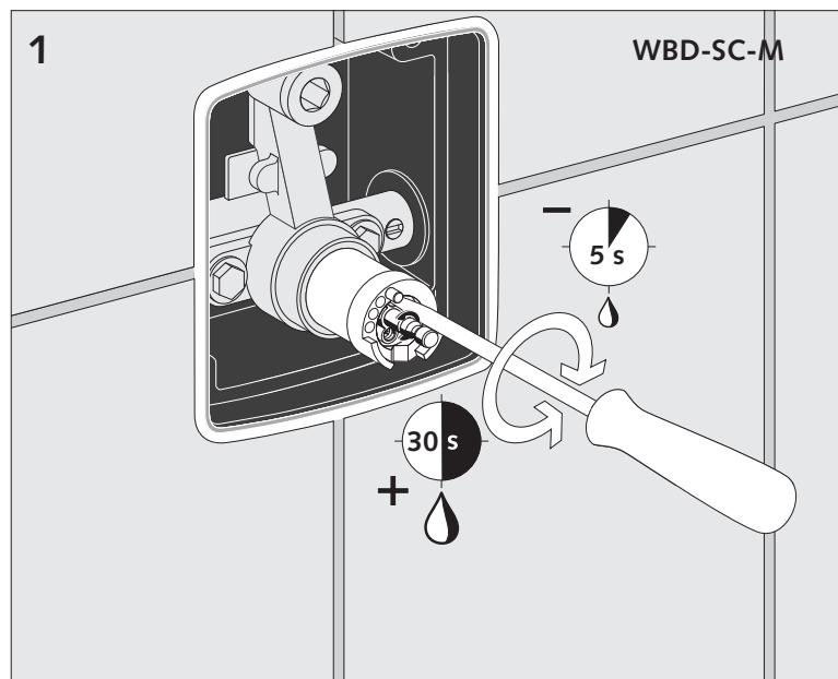
**(P)** • Ajuste de fábrica aprox. 25 – 30 s (3 bar pressão de fluxo), 35°C. Intervalo de ajuste aprox. 5 - 30 s.
